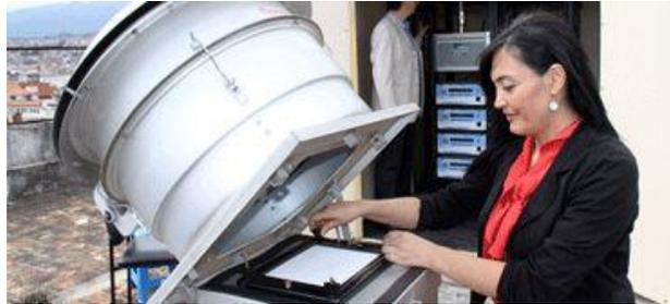
Funcionamiento la estación automática y meteorológica que miden los siguientes contaminantes: Monóxido de carbono, dióxido de azufre, dióxido de nitrógeno, material particulado PM2.5 y Ozono y variables: precipitación, temperatura, humedad, dirección, velocidad de viento y radiación solar total, respectivamente.
